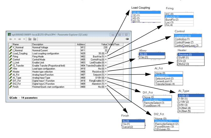
Figure 124 Quick code parameters
