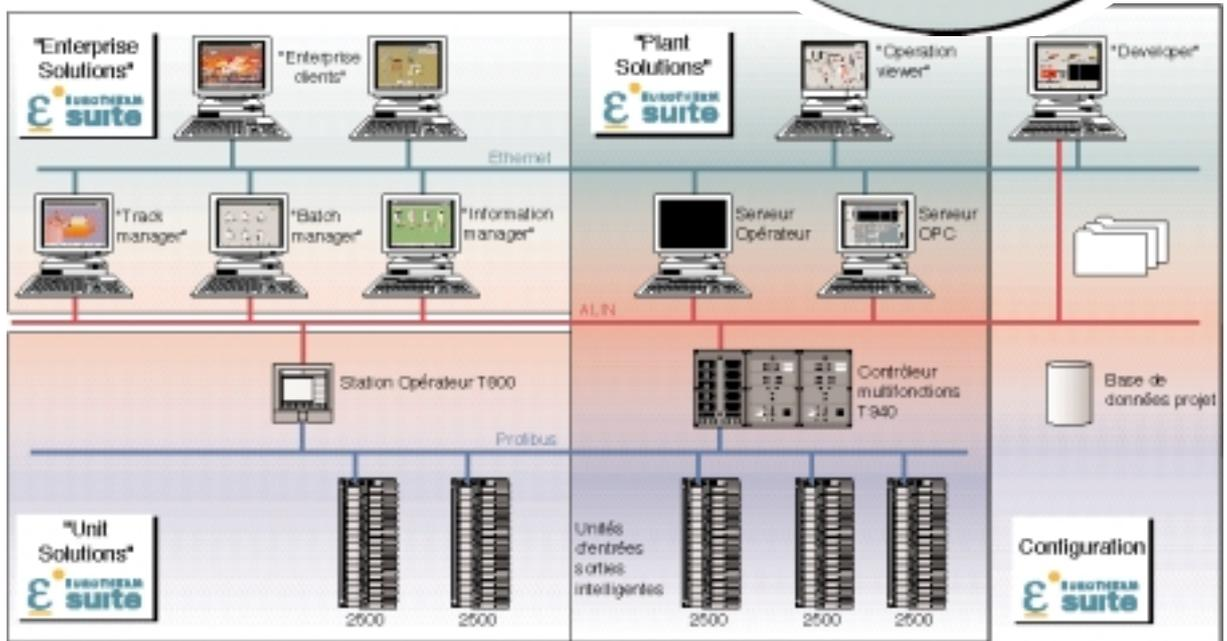
EUROTHERM PROJECT STUDIO est un ensemble d'outils d'ingénierie orientés objets qui permet de configurer et de mettre en service tous les composants de la suite Eurotherm (Unités d'Entrées/Sorties 2500, stratégie de contrôle et séquentiel, poste de conduite...)
