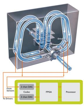
**Coriolis Flowmeter Diagram**
